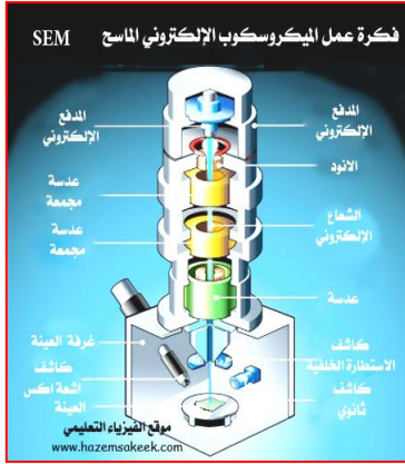
الشكل ( ٤ ) طريقة عمل المجهر الإلكتروني الماسح
