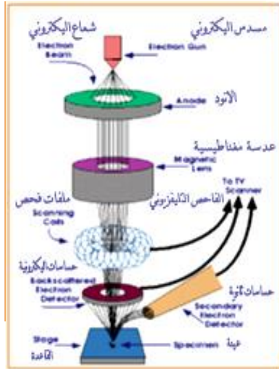
الشكل (٢) تركيب المجهر الالكتروني الماسح.
