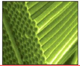
الشكل (٣) صف من أنابيب الكربون لتكوين مرشحات نانوية . مجلة التقدم العلمي، عدد ٦٦ ص ٢١
