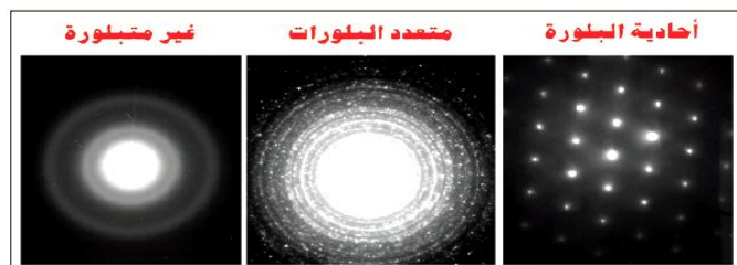
الشكل (٧) تبلور الحديد من نوع fcc بواسطة المجهر الالكتروني النفاذ .
