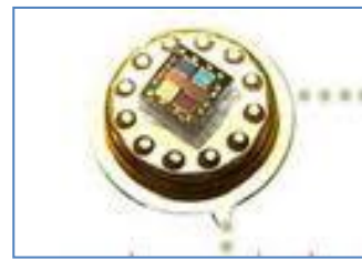
الشكل (١١) حساس نانوي مصنوع من أنابيب الكربون النانوية http://lmsat3.com
