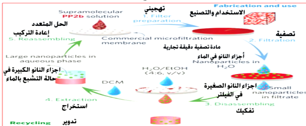
الشكل (٧) يوضح دور المرشحات النانوية في تنقية المياه
